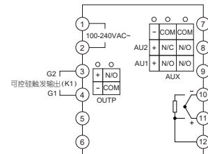
注 1: 热电偶应用补偿导线直接接入仪表后盖输入端子上, 中间不得转用普通导线连接, 并注意补偿导线型号与极性的正确。
